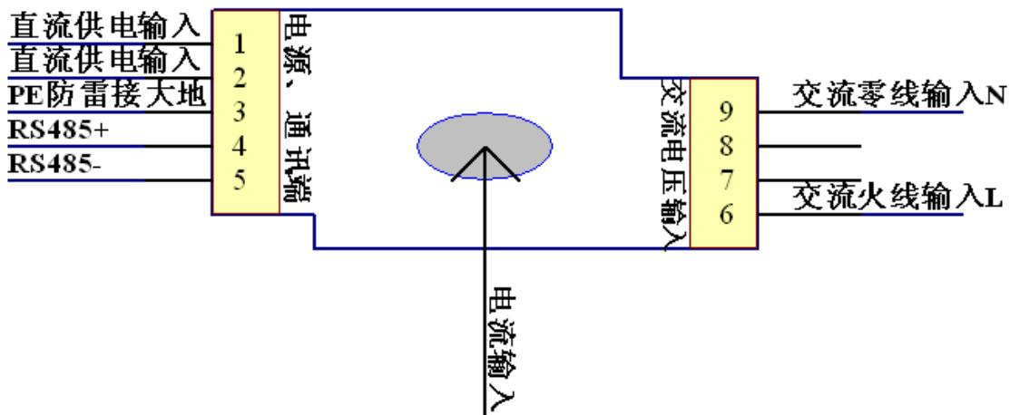
注: 接线图中第 1、2 接线端为直流电源输入接线端, 直流电压不分方向, 直流电压供电范围 12V~30VDC。
